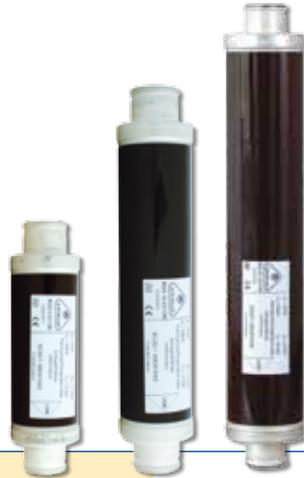
IKUS HH-Sicherungseinsätze sind mit Schlagstiften ausgerüstet, die dem Typ „mittel“ gemäß IEC 60282-1 bzw. DIN EN 60282-1 entsprechen. Die Standardtype mit 120N bietet darüber hinaus eine Thermoauslösung, diese schützt vor Überschreitung der Grenztemperatur von Sicherungsköchern in gasisolierten Schaltanlagen.
